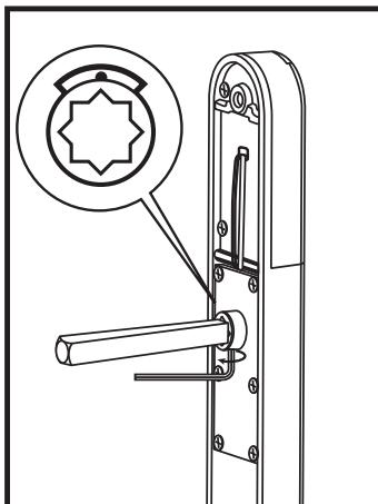
③ Setzen Sie die Spindel auf das Set des Außengriffs und ziehen die Spindel mit dem Sechskantschlüssel (Nr. 1.5) fest.
