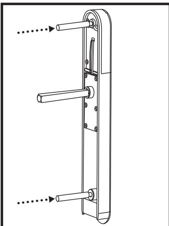
**4** Schrauben Sie zwei Befestigungsstangen an das Set des Außengriffs.
