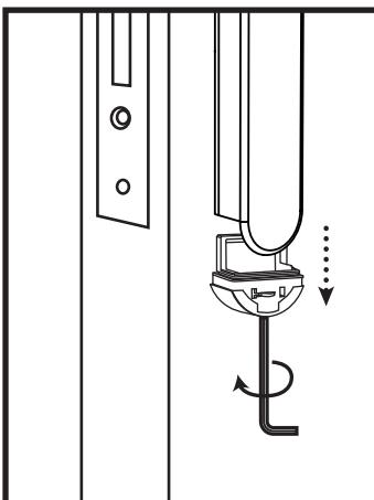
11 Drehen Sie die Schraube an der Unterseite des Außengriffs mit dem Sechskantschlüssel (Nr. 1,5) gegen den Uhrzeigersinn und ziehen Sie den Batteriehalter heraus.
