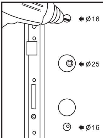
**2** Bohren Sie die Löcher an der Tür gemäß der Türbohrschablone.
