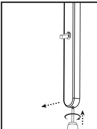
6 Drehen Sie die Schraube an der Unterseite des Sets im Uhrzeigersinn (nach innen), bis die Abdeckplatte herausgezogen werden kann.
