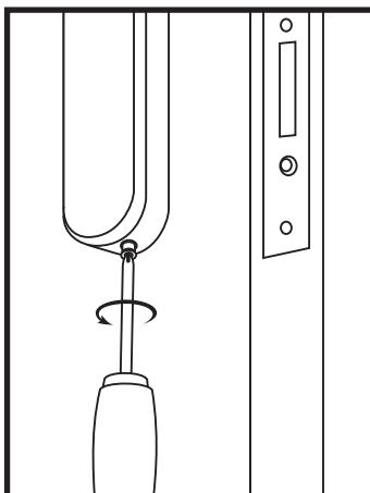
**9** Drehen Sie die Schraube am unteren Ende des Innengriffs gegen den Uhrzeigersinn (nach außen), bis Sie einen Widerstand spüren.
